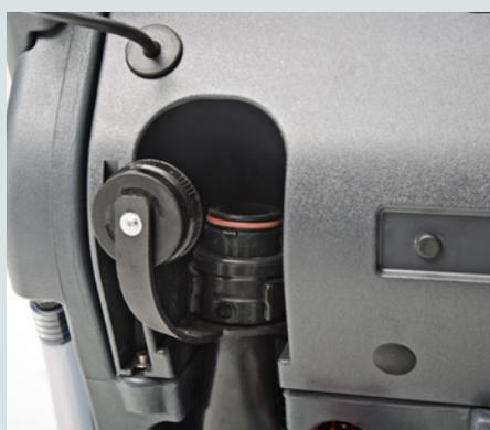
Машина оборудована сливным шлангом с мягкой сжимающей секцией, что позволяет осуществлять простой слив воды, а также изогнутыми скребками для улучшения результатов и сушки пола
